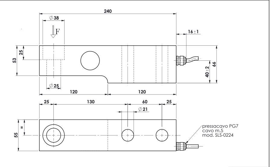
MATERIALE ACCIAIO INOX PORTATA 10.000 kg. SENSIBILITA' 2.5 mV/V protezione IP65 c 0 ÷ 30 ±0.10 8 30 ÷ 100 ±0.15 100 ÷ 300 ±0.25 300 ÷ 500 ±0.50 foro/alb H9 - h9 sm. e raggi 0.5
