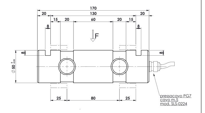
MATERIALE ACCIAIO INOX PORTATA kg.10.000 SENSIBILITA' 1 mV/V protezione IP 68
