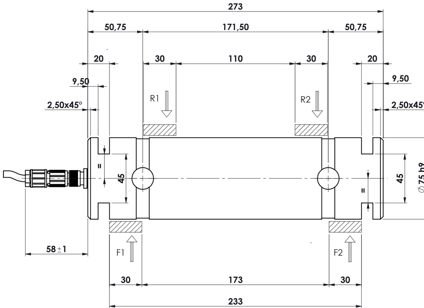
Connettore mod. M12 + contropresa (metallo) cablata a mt. 5 di cavo mod. SLS-0224
