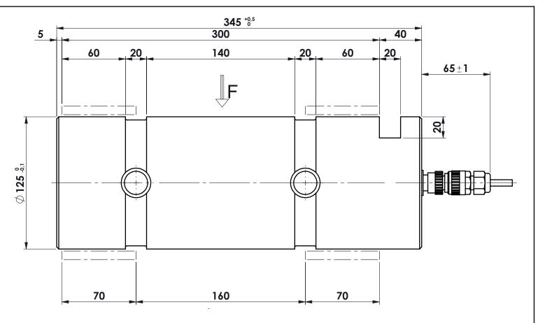
MATERIALE ACCIAIO INOX PORTATA 145.000 kg scheda amplificata di uscita SENSIBILITA': ± 0÷10V - 24Vcc protezione IP67 marchiatura: ALAUZ-145T
