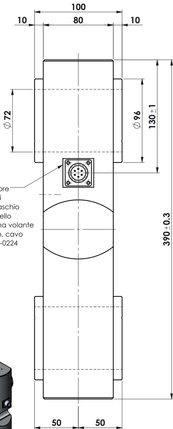
Connettore mil. 6 poli presa maschio da pannello + femmina volante con 10 m. cavo mod. SLS-0224
